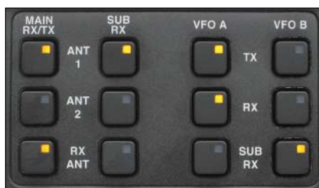
Bild 2: Schaltfeld oder Matrix. Hier wird festgelegt, wie die Empfänger mit den beiden VFOs und drei möglichen Antennen zusammenarbeiten. Die in die Tasten integrierten LEDs zeigen den aktuellen Zustand.
