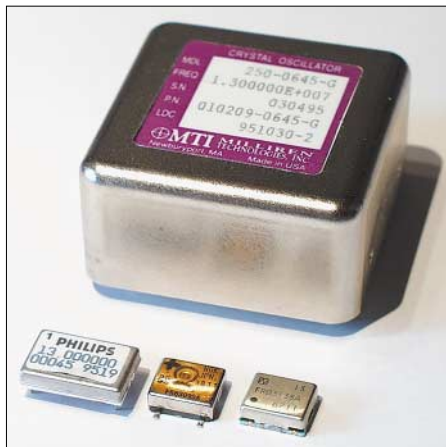
Bild 2: Im Hintergrund ist ein hochstabiler 13-MHz-OCXO von MTI zu sehen – den Vordergrund nehmen drei verschiedene TCXOs anderer Hersteller ein. Zur Orientierung sei gesagt, dass gute Typen eine Frequenzstabilität von etwa 1 ppm besitzen.
