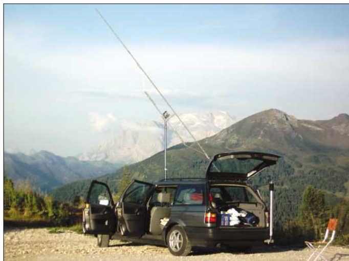
Ein Platz an der Sonne – die Antenne auf den Mond gerichtet. Mittels eines an der 12-V-Autobatterie betriebenen DJ9YW-Transverters (Typ BJ 250 A, Input 50 MHz/4 W, Output auf 1296 MHz bis zu 100 W) sowie einer 5 m langen 59-Element-Yagi für 23 cm (19,7 dB Gewinn) wurden von Korsika und Sardinien 13 JT44-EME-QSOs gefahren.
