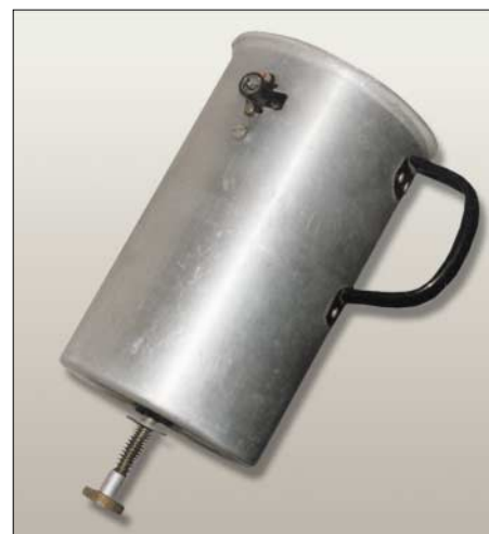
Über die Korrekturschraube im Boden wurde die wirkende Kapazität verändert, womit eine Feinabstimmung auf die Störfrequenz möglich war. Fotos: DL2LUX
