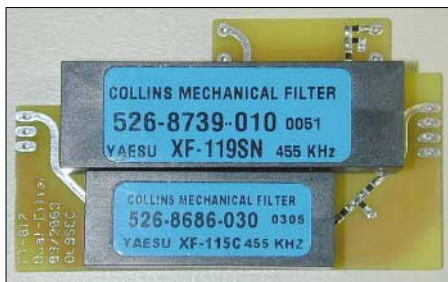
Bild 1: Das komplett mit Dämpfungsgliedern und Filtern bestückte Adapterboard ist fertig für den Einbau.
