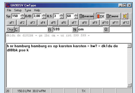
Bild 3: CwType stellt in Verbindung mit der PC-Tastatur eine komfortable Morseschreibmaschine dar.
