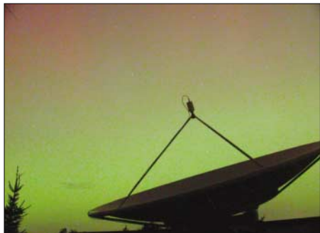
3-m-Spiegel von DL3HRT vor dem Polarlicht. Noch ist ein SAT-LNB montiert. Im nächsten Frühjahr beginnen EME-Versuche auf 23 cm mit einem Septum-Feed. Fotos: DL3HRT
