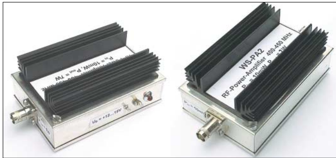
Bild 1: Fertig aufgebaute UHF-Verstärker für 433 MHz, P_{in} = 10 \text{ mW} , P_{out} = 7 \text{ W}
